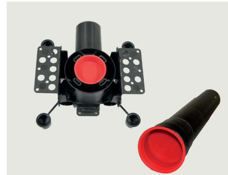
Bild 7. Die Luftdichtheit wird überprüft in dem man alle Saugdosen oder Montagebauteile mit Hilfe eines Verschlussstopfens (DPI-66 und DPI-70) verschließt.
