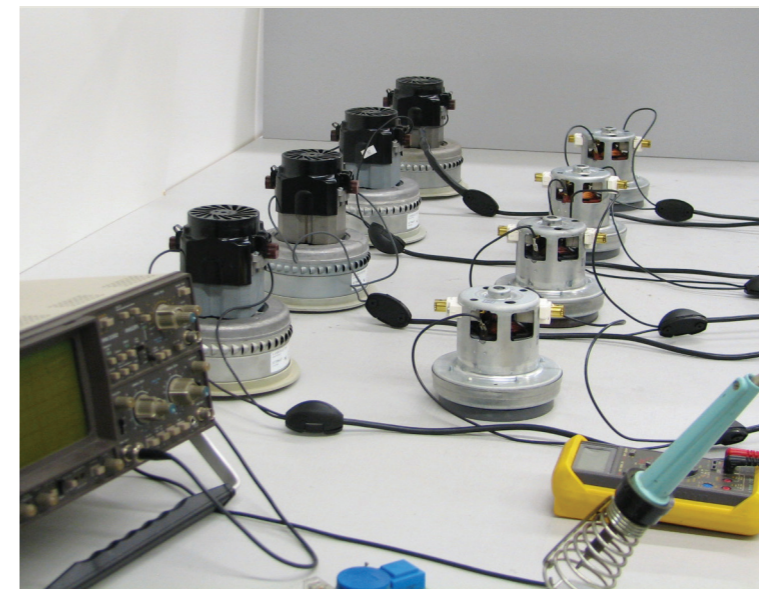
Bild 6. Lebensdauertests für Turbinen werden im eigenen Labor von ALLAWAY durchgeführt.
