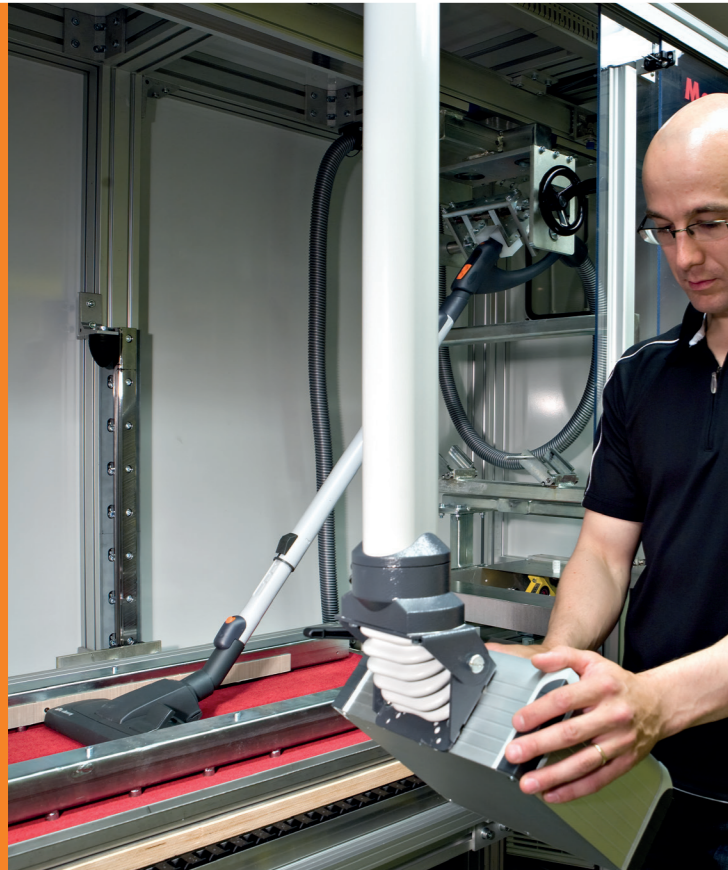
Bild 8. Staubaufnahmetests können verwendet werden um die Kapazität der verschiedenen Saugdüsen auf verschiedenartigen Saugflächen zu testen z.B. auf harten Böden oder eine Serie von verschiedenen Teppichen.
